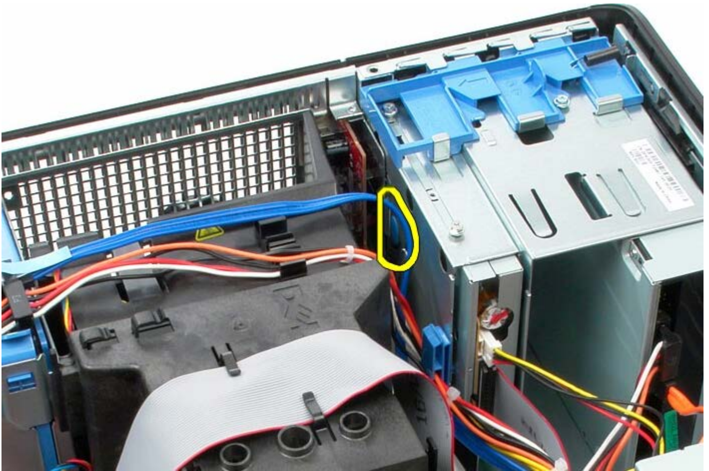
1 11 IO 패널을 시스템 뒤쪽으로 기울이십시오.
